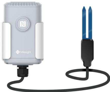
EM500-SMT está diseñado para medir la humedad del suelo en entornos hostiles y transmitir datos mediante la tecnología LoRaWAN®. Con esta tecnología de bajo consumo de energía, EM500-SMT puede funcionar hasta 10 años con una batería de 19000 mAh. En combinación con la puerta de enlace Milesight LoRaWAN® y la solución Milesight IoT Cloud, los usuarios pueden gestionar todos los datos de los sensores de forma remota y visual.
